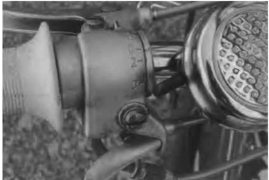
Combinatie tussen een koppelhandle en een Sachs-draaigreep
